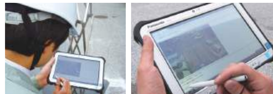
【監視エリアの設定と警報発生時のデータ記録】 タブレット型のエリア指定制御装置により、現場で監視エリアを任意に設定できます。
