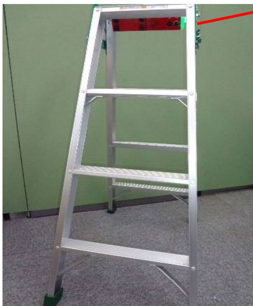
脚立に警報システムを取り付けた状態
