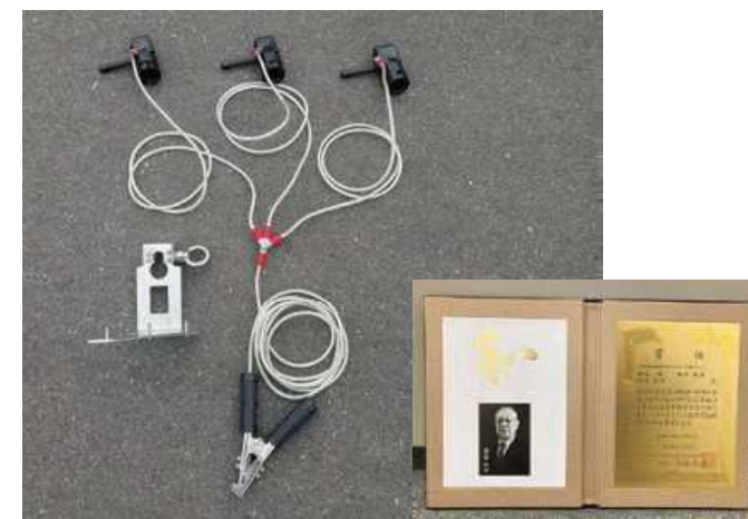
PD線用接地短絡器具とアースクランプ[共同開発:大東電材] ※特許第6913321号 ホットスティックを使用しての取付および取外しが、作業員1名で可能となり、作業効率の向上と安全性の向上が図れるため全事業場に配備しています。また、本工具は第66回濫濁賞を受賞しました。
