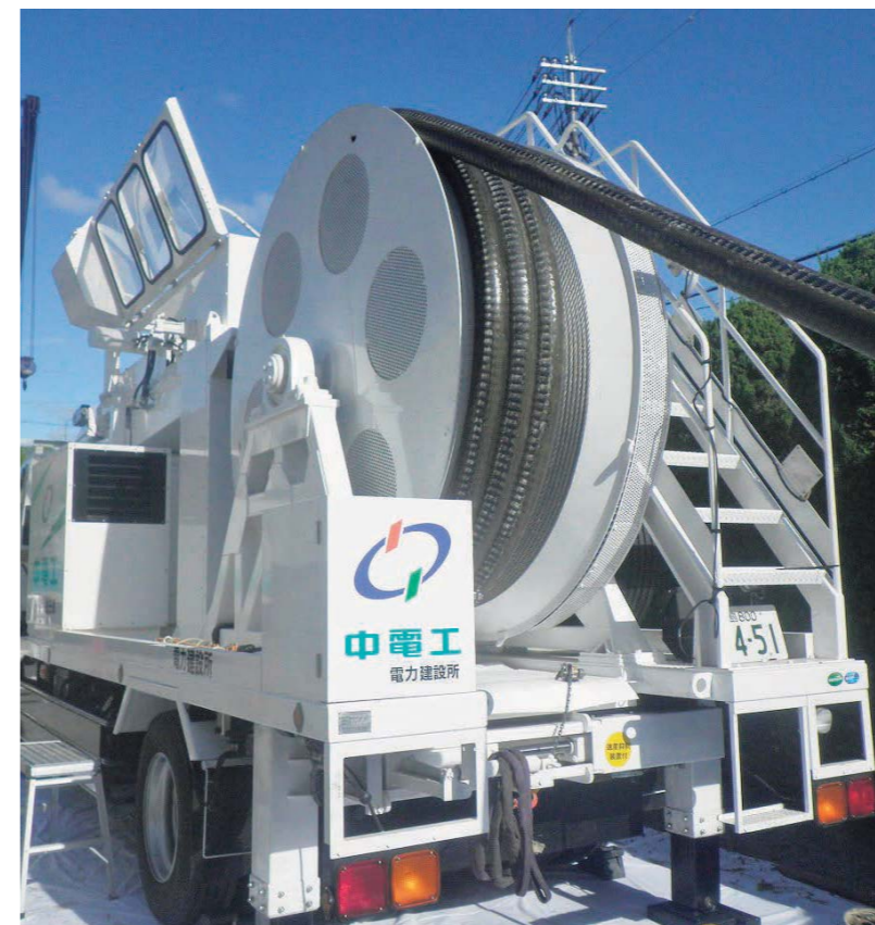
OFケーブル張替工事【ケーブル撤去車】 Replacement of OF Cable(Cable Removal Truck)
