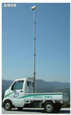
空圧ポンプ (電動) によりポールを 6m 延長する。
