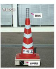
警報エリアに人が入ると警告灯の交互点灯および 音声装置により警告する。
