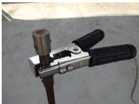
アースクランプを 接地棒に取付
